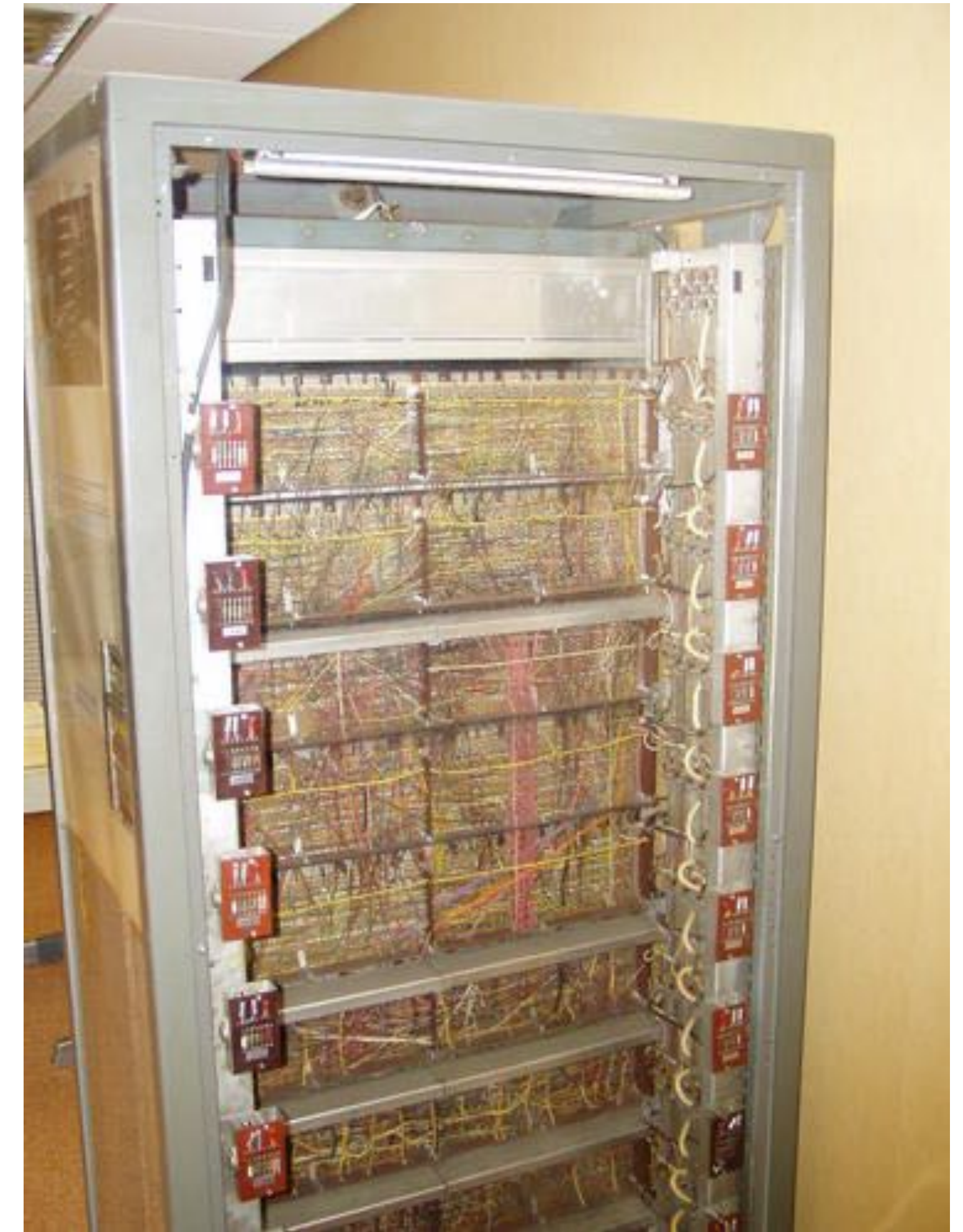
The Atlas: backplane wiring
