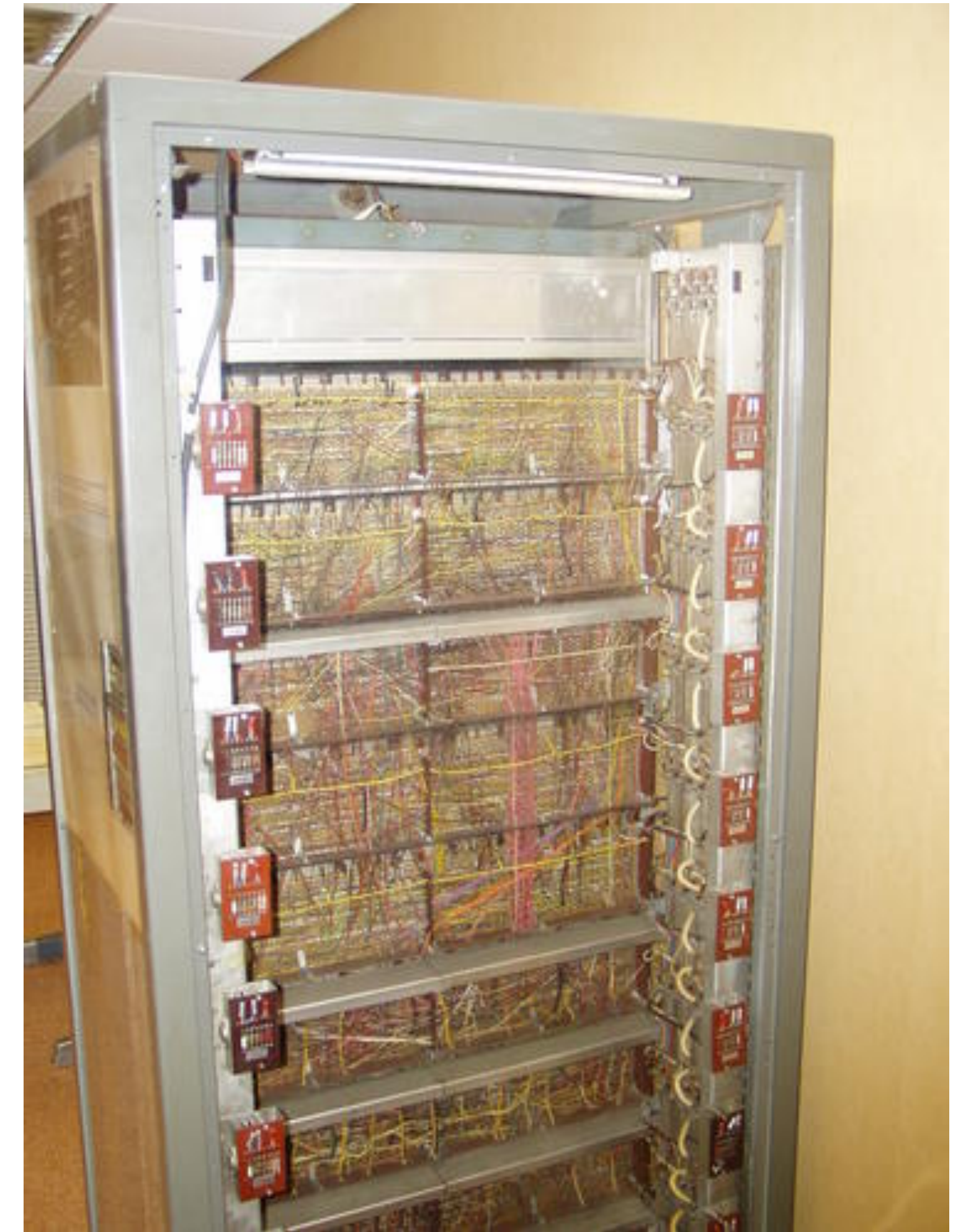
The Atlas: backplane wiring
